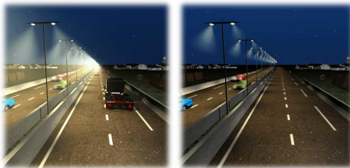
Fig. 40. Nivele de dimming în funcție de fluxul de trafic
