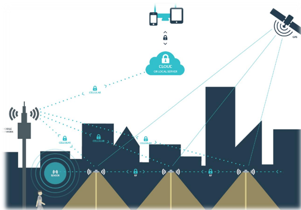
Fig. 39. Schema sistem de management prin telegestiune
