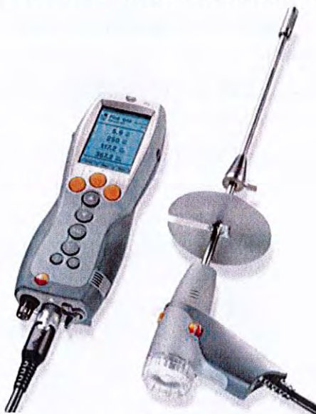
Fig. 4.2. Analizorul de gaze multifuncțional TESTO 335
